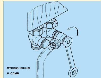
Все узлы RLV-K фирмы Данфосс на заводе настраиваются на работу в двухтрубной системе. В случае установки клапана в однотрубную систему, необходимо открыть байпас, повернув торцевой ключ на количество оборотов, соответствующее требуемому коэффициенту затекания.
